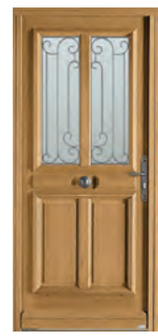
Vantail épaisseur 80 mm , double vitrage givré, grille finition rustique, châssis ouvrant en partie haute, bouton côté extérieur, poignée sur plaque finition rustique côté intérieur / extérieur Ud : 1,4
